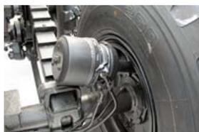
Также в моделях Урал-М реализовано пневматическое управление рабочей и стояночной системой тормозов. Применение комплектующих системы пневматического привода тормозов фирмы WABCO обеспечивают большую надежность, снижение затрат на ТО.
