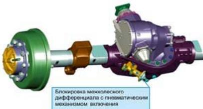
Для повышения проходимости и улучшения вездеходных качеств автомобиля все базовые модели новой линейки автомобилей Урал-М оснащаются блокировкой межколесного дифференциала (МКБ). Механизм блокировки устанавливается на среднем и заднем мосту грузовиков. Управление блокировкой межколесного дифференциала осуществляется системой пневматического привода.
