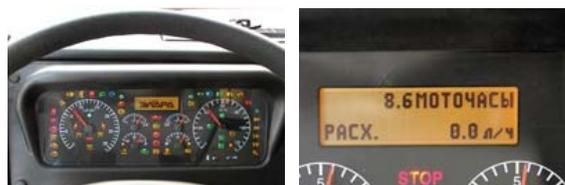
Помимо прочего в автомобилях Урал-М устанавливается **новый щиток приборов с комбинацией контрольных индикаторов и монохромным жидкокристаллическим дисплеем**, отображающим информацию диагностических систем автомобиля, обеспечивающих контроль и своевременное выявление неисправностей. Также грузовые автомобили Урал-М **оснащены счетчиком моточасов**.
