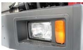
Обзор дороги в темное время суток обеспечивают фары головного света. Отличительной особенностью элементов освещения дороги Урал-М является **прозрачный элемент фар**, изготовленный из **стекла**. Стекло в отличие от пластика не мутнеет со временем и не зашаркивается, что влияет на качество освещения.
